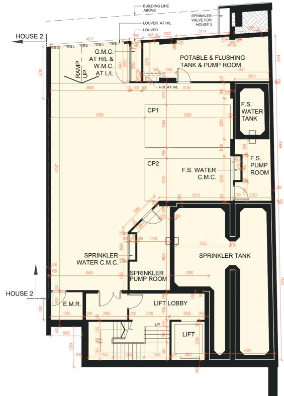
LOWER GROUND FLOOR PLAN 低層地下平面圖
