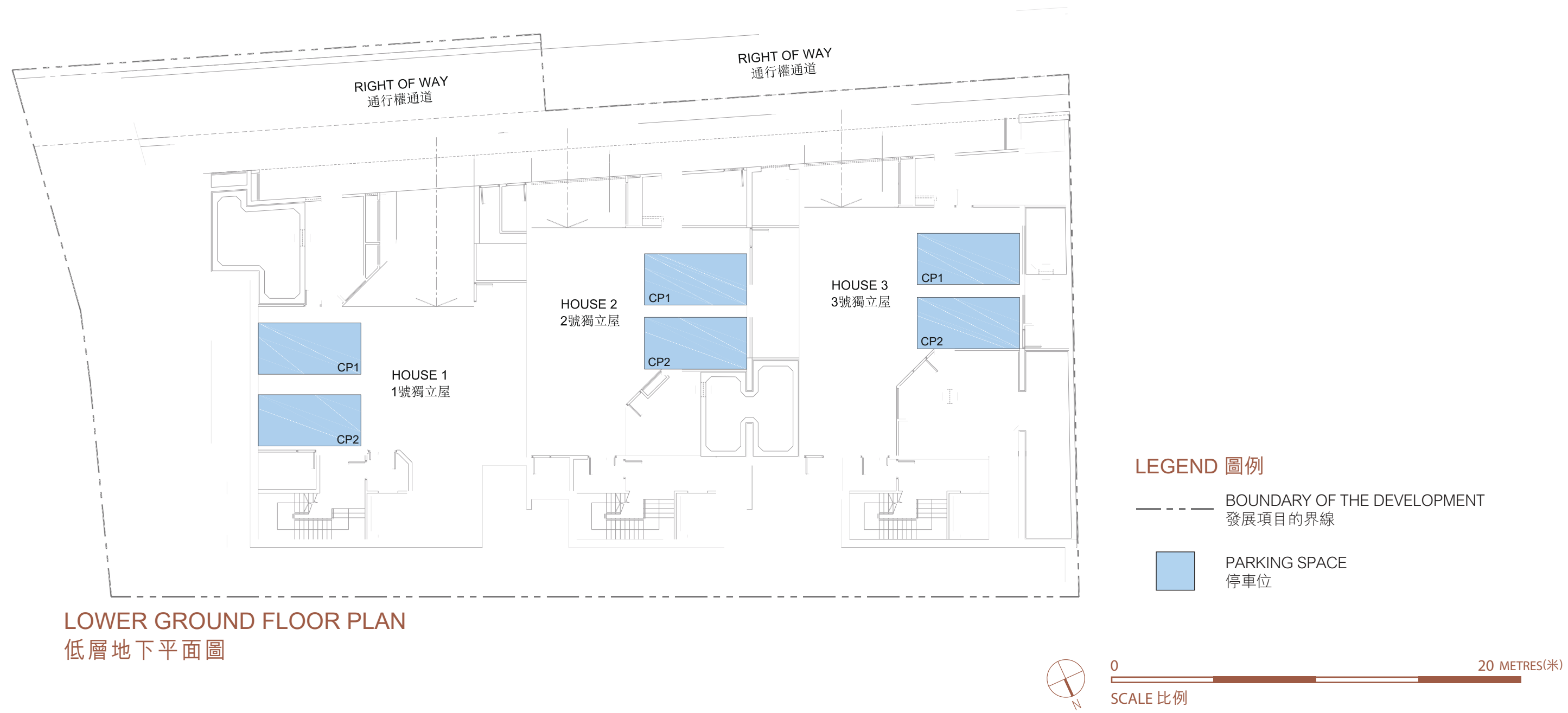
Location, Number, Dimensions and Area of Parking Spaces 停車位的位置、數目、尺寸及面積
